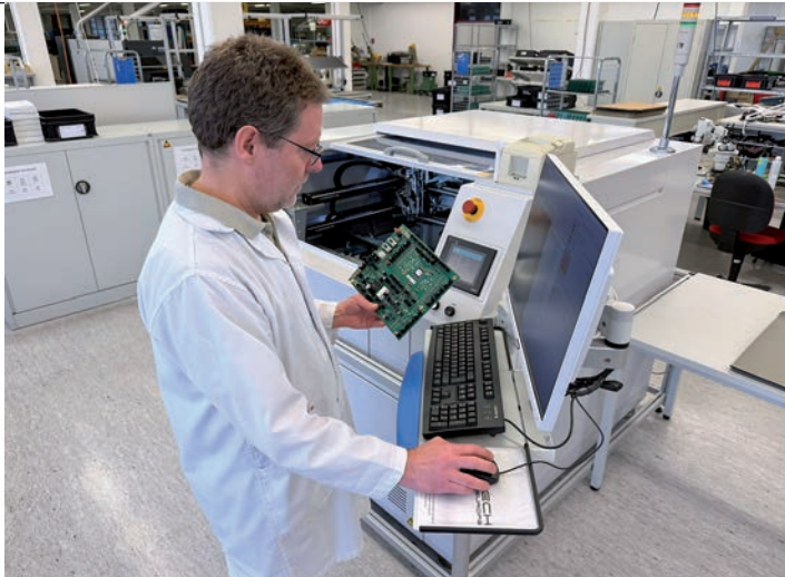
Das Unternehmen hat in den vergangenen drei, vier Jahren in einige Produktionsanlagen investiert, so etwa in das Flying-Probe-Testsystem von Takaya (links) oder die 3D-AOI von Parmi. (Bilder: Hadimec)
